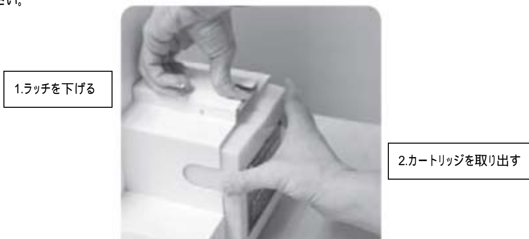
図2.2 カートリッジの受け箱からカートリッジを取り出す
